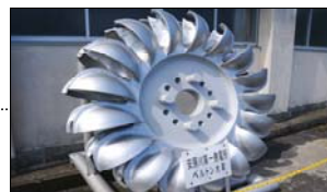
屋久島電工安房川第一発電所 ペルトン水車
